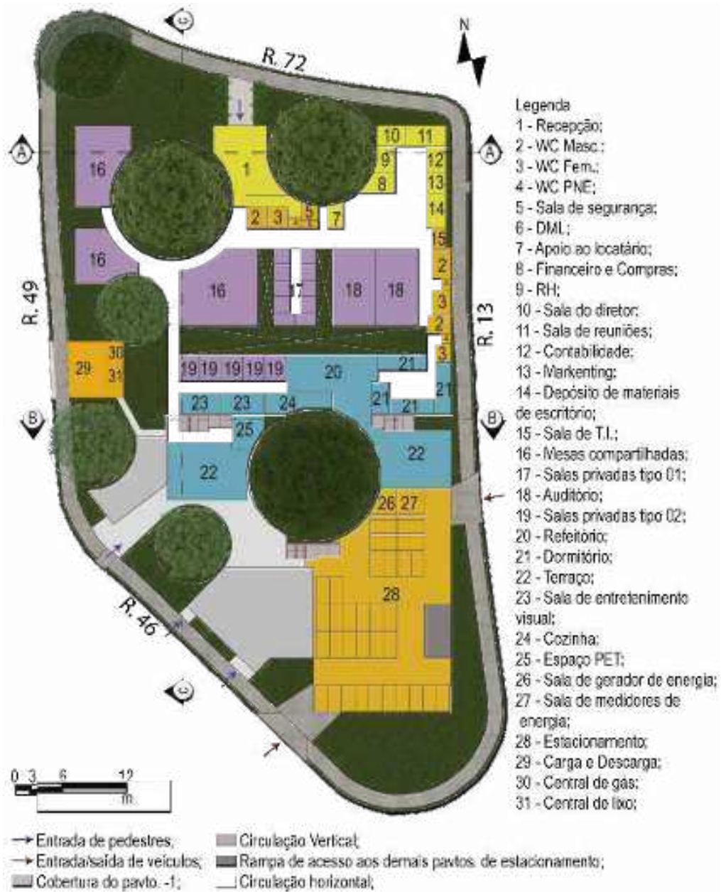
Figura 51 - Implantação com pavto. térreo
